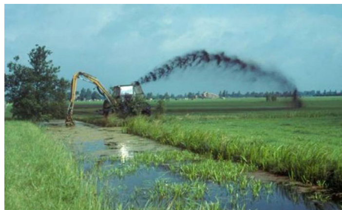
Figuur 15: Werking van de baggerpomp bevestigd aan een tractor (bron: © Theo de Jong).
