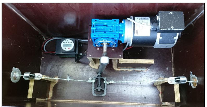
Foto 1. Aandrijfsysteem van de krekkel. Linksboven is de tijds klok met zender te zien. Deze activeert de motor (rechtsboven). Aan de toerenreductiekast (blauw) zit de trapas en trapper verbonden. Aan de trapper zitten de touwen verbonden die de krekels aandrijven. Foto: J.Snijders.
