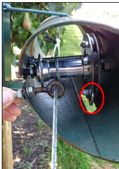
Foto 3. As midden in krekels met daaraan de naaf met drie schakels (één schakel rood omcirkeld). Deze wordt aangedreven via een touw door de motor. Achteraan zit het draadeind waar de schakels tegen slaan. Foto: J. Snijders
