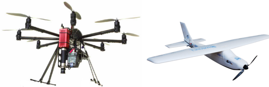
Figuur 4.4 Multicopter met hyperspectrale camera en een fixed wing vliegtuigje met fotogrammetrische camera.
