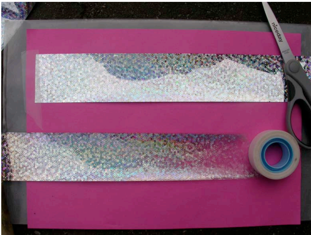
Figuur 8. Boven een niet gebruikt stuk Irritape en onder een stuk Irritape, waarvan het holografisch materiaal (aan de linkerkant) ten dele is verdwenen.
