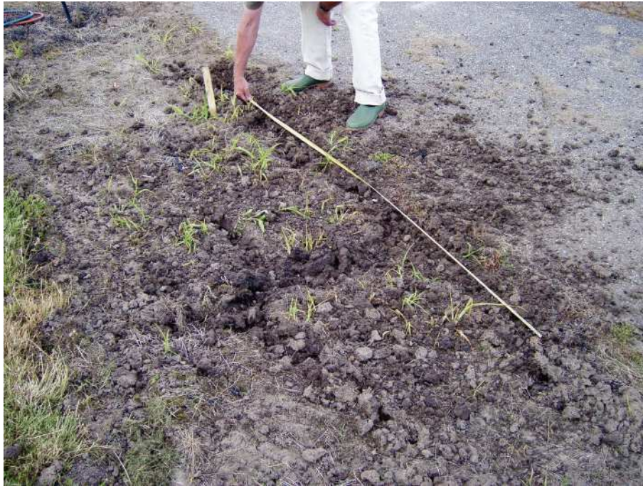
Foto 19. Opmeten van de afstand met zichtbare schade na behandeling met de Rodenator Pro.
