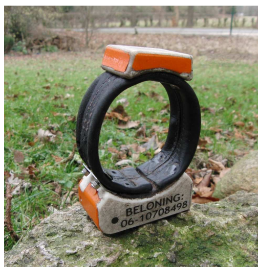
Figuur 2. Halsbandzender zoals gebruikt in 2010. Bovenop de GPS-module, onderaan de behuizing voor batterijen en peilzender. Beplakt met oranje reflecterend materiaal. Dit exemplaar was de zender van vos Jorrit, na gebruik.
