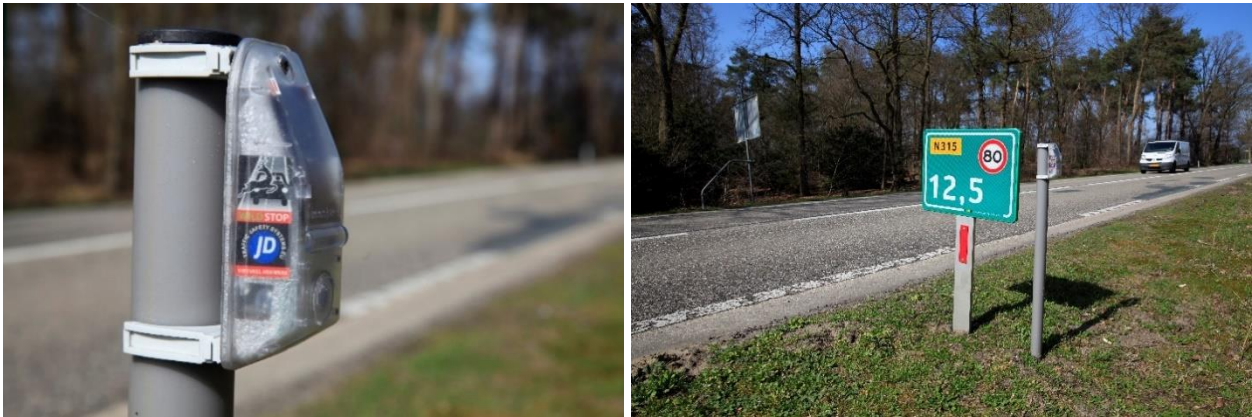
Figuur 2.4 De modules van het virtuele hekwerk (links) zijn op pvc-paaltjes bevestigd op een hoogte van circa 60 cm (rechts).
