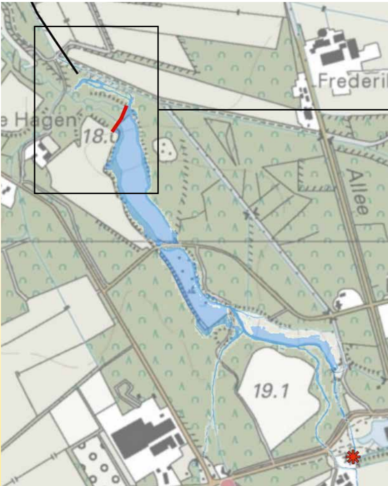
Figuur 2. Een voorbeeld uit Staverden, bij De Hagen. Links: AHN-simulatie waarop te zien is wat er zou gebeuren als er bij De Hagen een stuw (rood) zou worden geplaatst en het water daar 1 meter boven de beekdalbodem zou worden opgestuwd. Alles lager dan 16,5 meter +NAP is blauw gemaakt.
